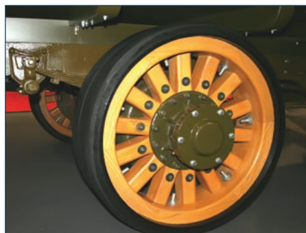
Точкови су направљени од јасеновог дрвета на које је посебним алатом наливена гума
